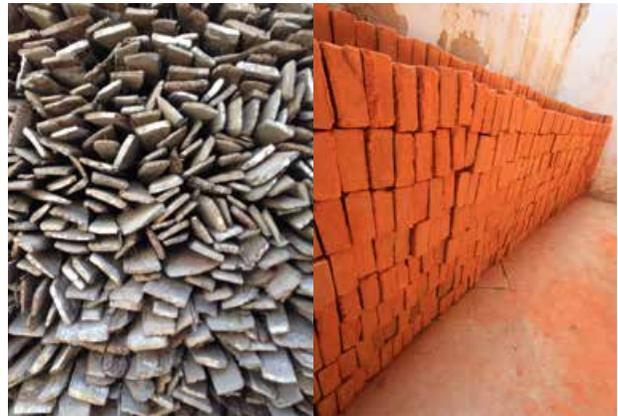
Biliguanas rescatadas para su reintegración y ladrillo de barro rojo recocido para reforzamiento estructural.
