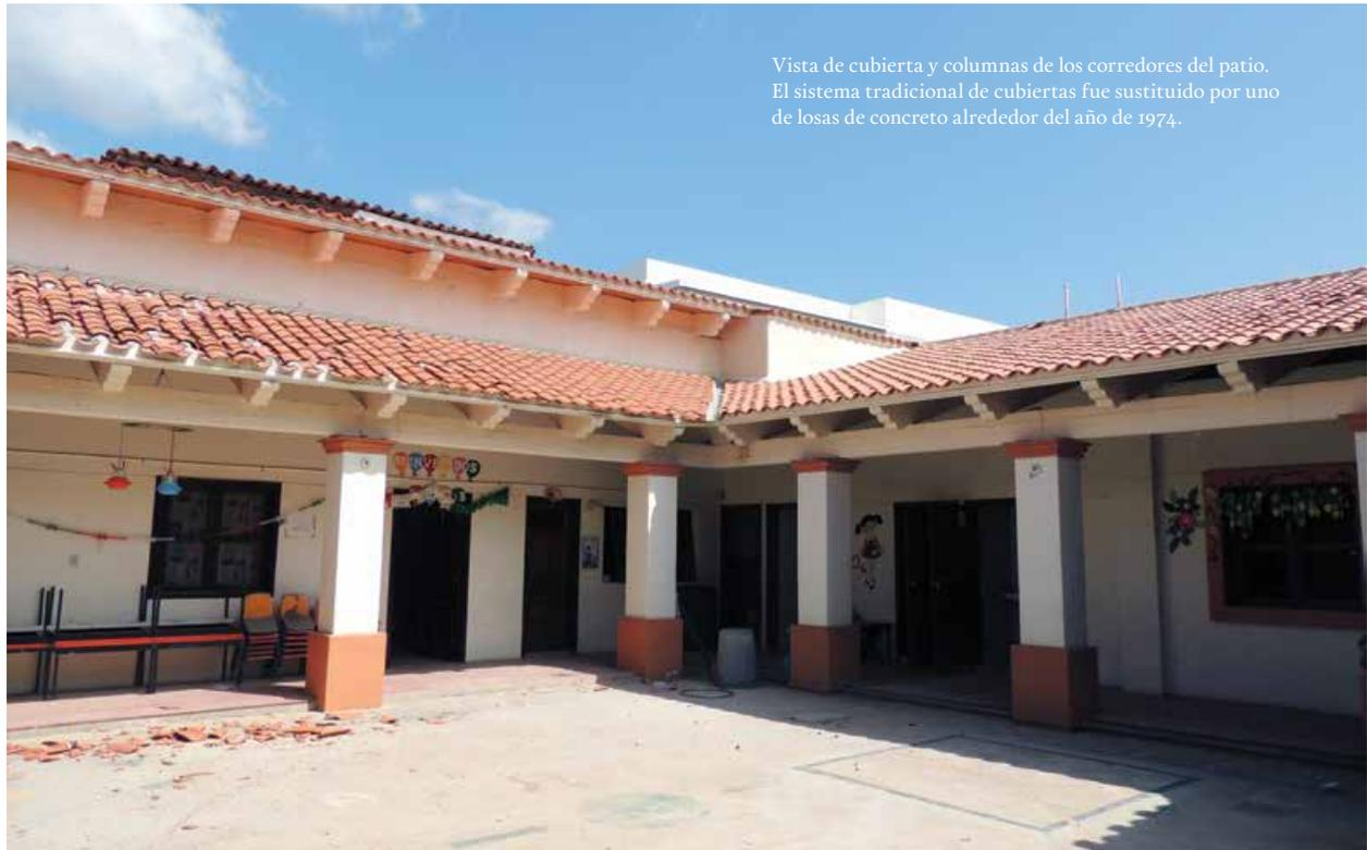
Vista de cubierta y columnas de los corredores del patio. El sistema tradicional de cubiertas fue sustituido por uno de losas de concreto alrededor del año de 1974.
