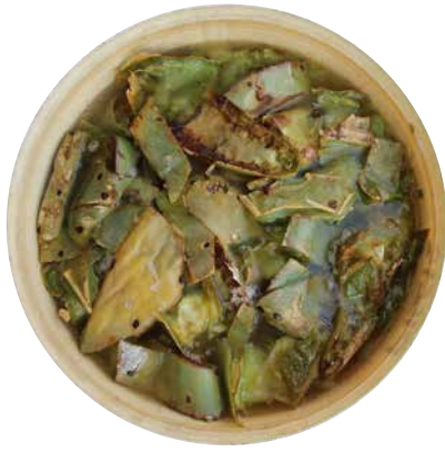
Uso de mucílago de nopal en aplanados y pintura, elaborados a base de cal.
